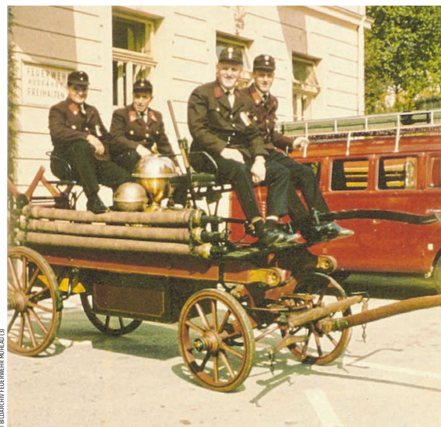
Die erste Mühlauer Spritze von 1875: eine handbetriebene Pumpe mit Saug- und Druckbetrieb auf einer Pferdekutsche (hier bei der 90-Jahr-Feier)
